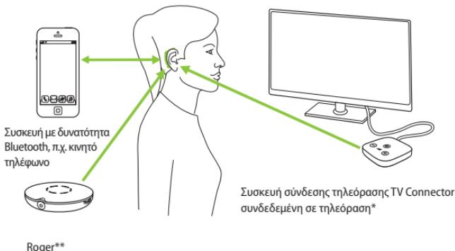
\* Η συσκευή σύνδεσης τηλεόρασης TV Connector μπορεί να συνδεθεί σε οποιαδήποτε πηγή ήχου, όπως τηλεόραση, υπολογιστής ή στερεοφωνικό σύστημα.
